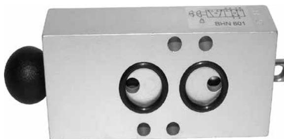
**BHN 601 01** hat die gleiche Funktion wie die BHN 601. Sperrfunktion ist in der M-Position. Zusätzlich hat das Ventil einen Stift, um in der O-Stellung zu fixieren.
